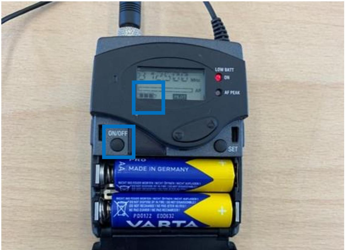
Schalten Sie das Mikrofon ein. Überprüfen Sie die Batterieladung. Wechseln Sie bei Bedarf die Batterien.
