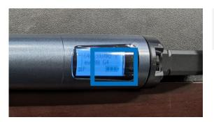
Überprüfen Sie die Batterieladung. Wechseln Sie bei Bedarf die Batterien.
