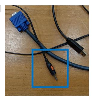
In den Hörsälen 2A und 2D erfolgt die Medienton-Ausgabe im Gegensatz zu anderen Hörsälen nicht über das HDMI-Kabel des Projektors.
