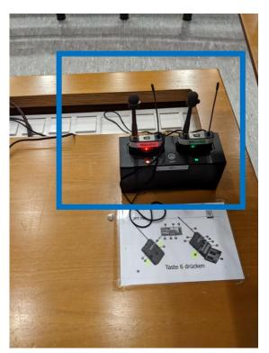
Nehmen Sie eines der beiden Funkmikrofone aus dem Ladegerät.
