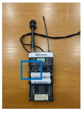
Öffnen Sie die Klappe am Funkmikrofon und schalten Sie das Mikrofon über den On/Off-Schalter ein.
